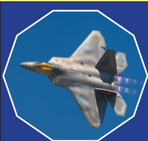
بال ذوزنقه‌ای (Trapezoidal Wing)
