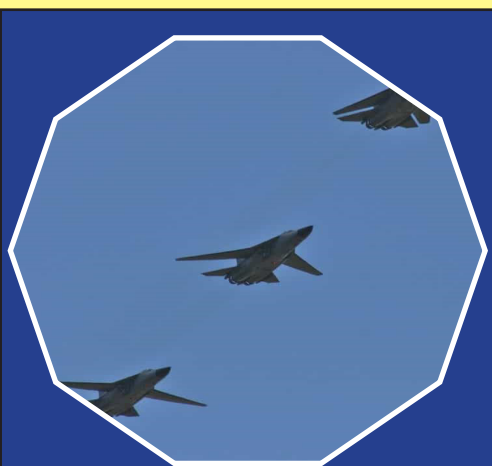
بال جارویی متغیر (Variable Sweep Wings)
